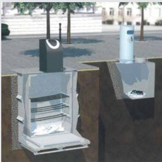
Das Prinzip der Unterflursysteme in dreidimensionaler Darstellung
